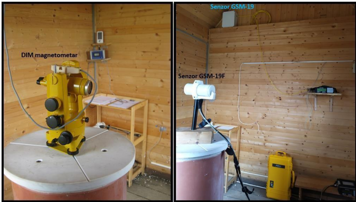
Slika 1.5 – Lijevo: Deklinacijsko-Inklinacijski magnetometar na pilaru u A kući. Desno: Mjerenja totalnog intenziteta F u A kući. Senzor GSM-19 magnetometra (u plastičnoj kutiji) permanentno mjeri F na udaljenosti od 2,5 metra od A pillara. Senzor GSM-19F magnetometra koji povremeno mjeri na referentnom A pillaru.
