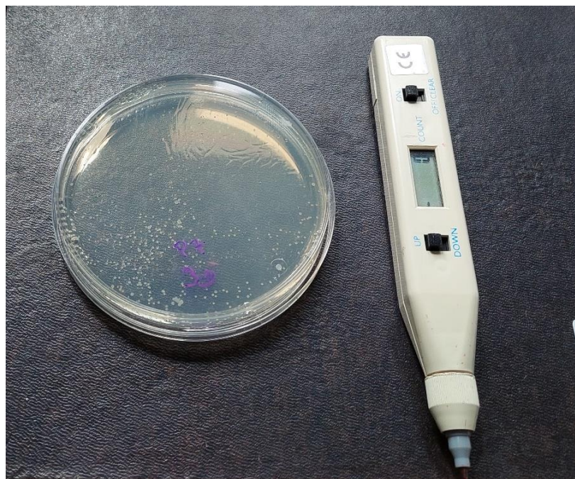
Slika 3.4. Uređaj Colony counter za prebrojavanje bakterijskih kolona.
