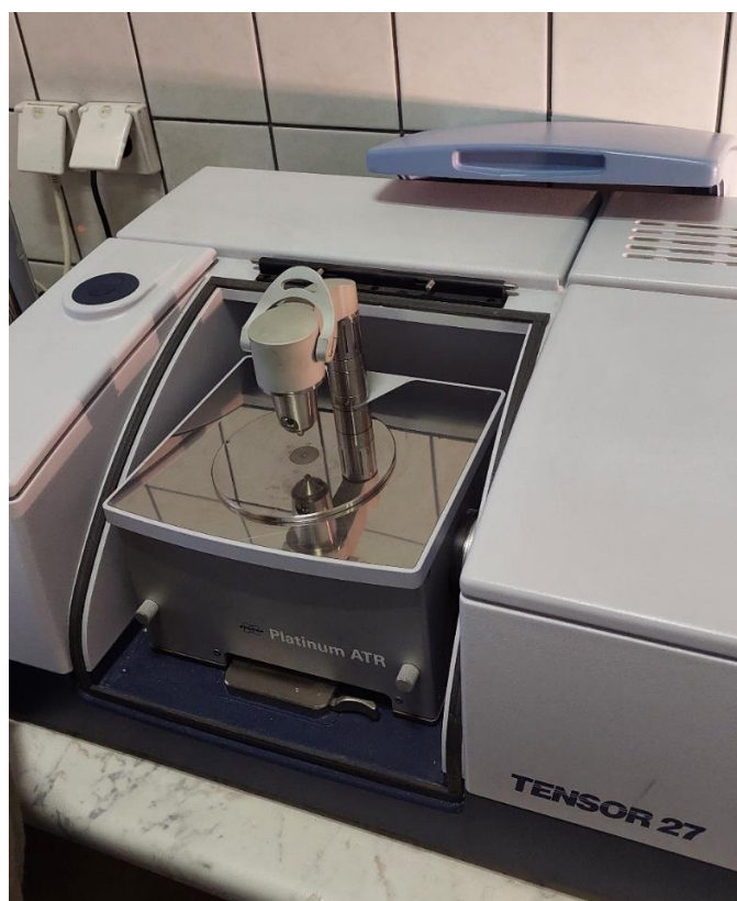
Slika 3.13. Tensor 27 FTIR spektrometar.
