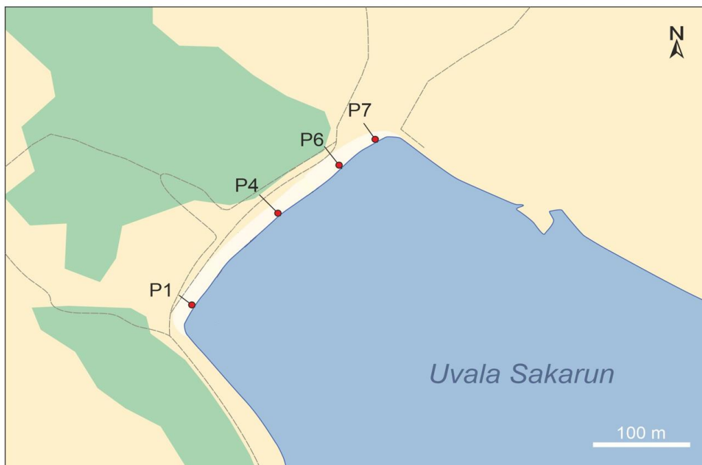
Slika 3.6. Položaji profila na litoralnoj zoni plaže Sakarun. Na profilima P1, P6 i P7 je uzorkovan sediment za mikrobiološku analizu, na profilima P4 i P7 za sedimentološku analizu te na profilima P1, P4 i P7 za analizu teških metala.
