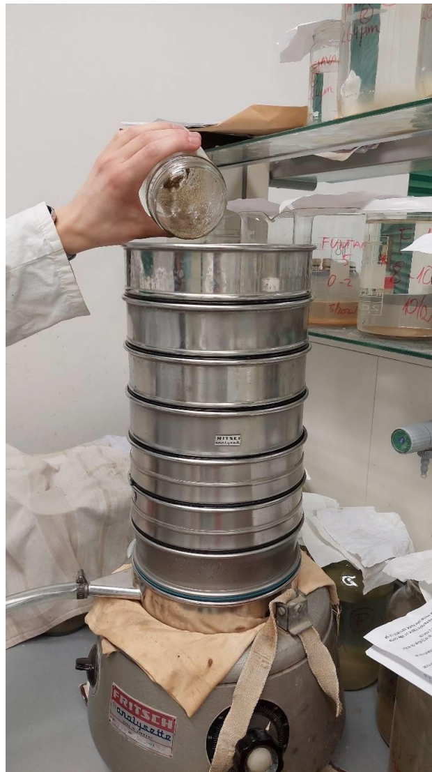
Slika 3.7. Komplet Retsch® ASTM sita, Geološko-paleontološki zavod PMF-a.
