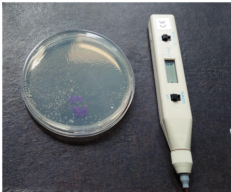
Slika 3.4. Uređaj Colony counter za prebrojavanje bakterijskih kolona.
