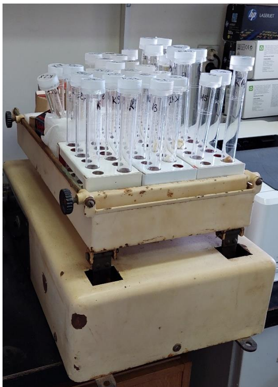
Slika 3.9. Kivete s uzorcima na linearnoj tresilici.
