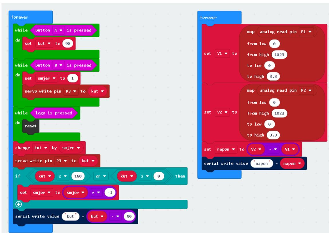
Slika 4.3: Programski kôd za mjerenje inducirano napona
