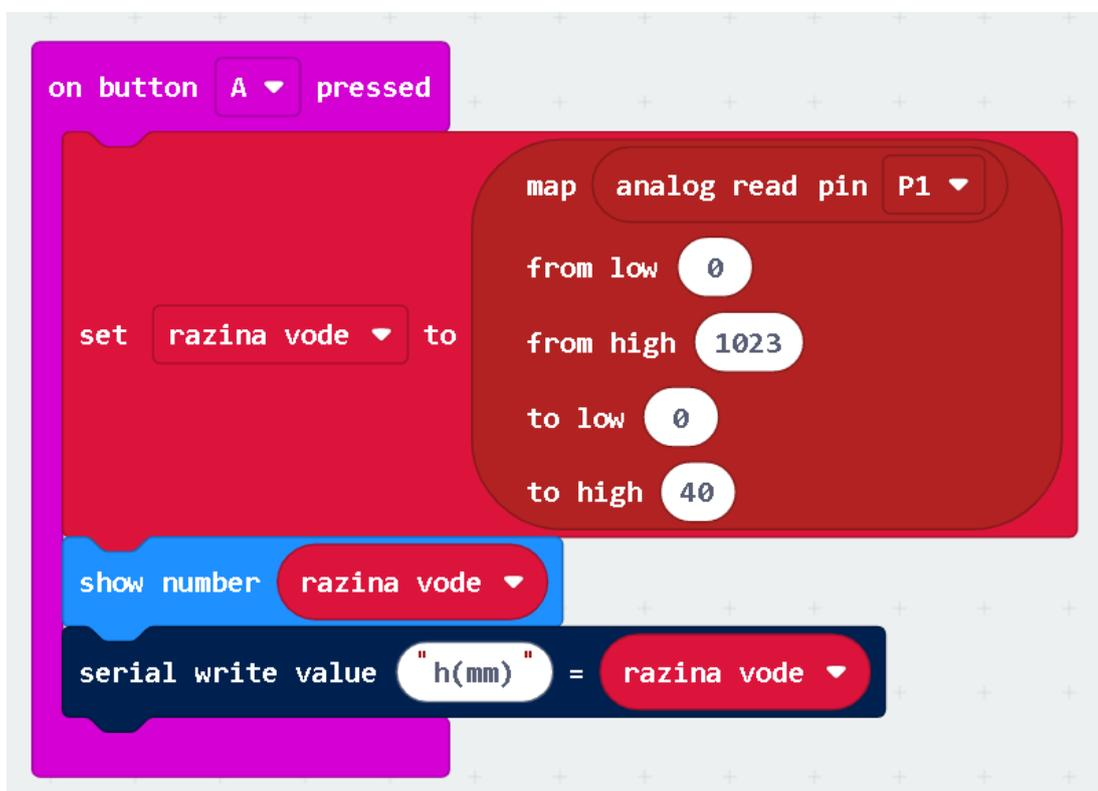
Slika 3.3: Programski kôd za mjerenje volumena nepravilnog tijela
