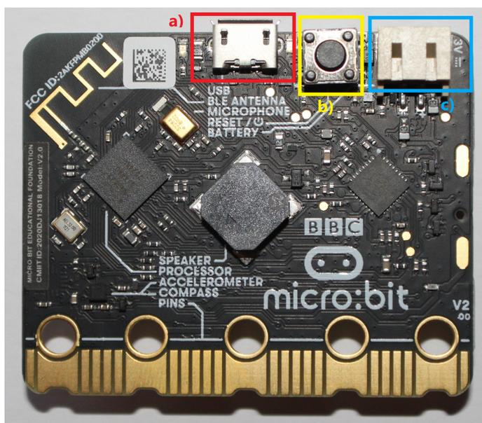
Slika 1.2: Stražnji dio micro:bit-a a) USB utor, b) tipka za ponovno pokretanje, c) utor za baterije
