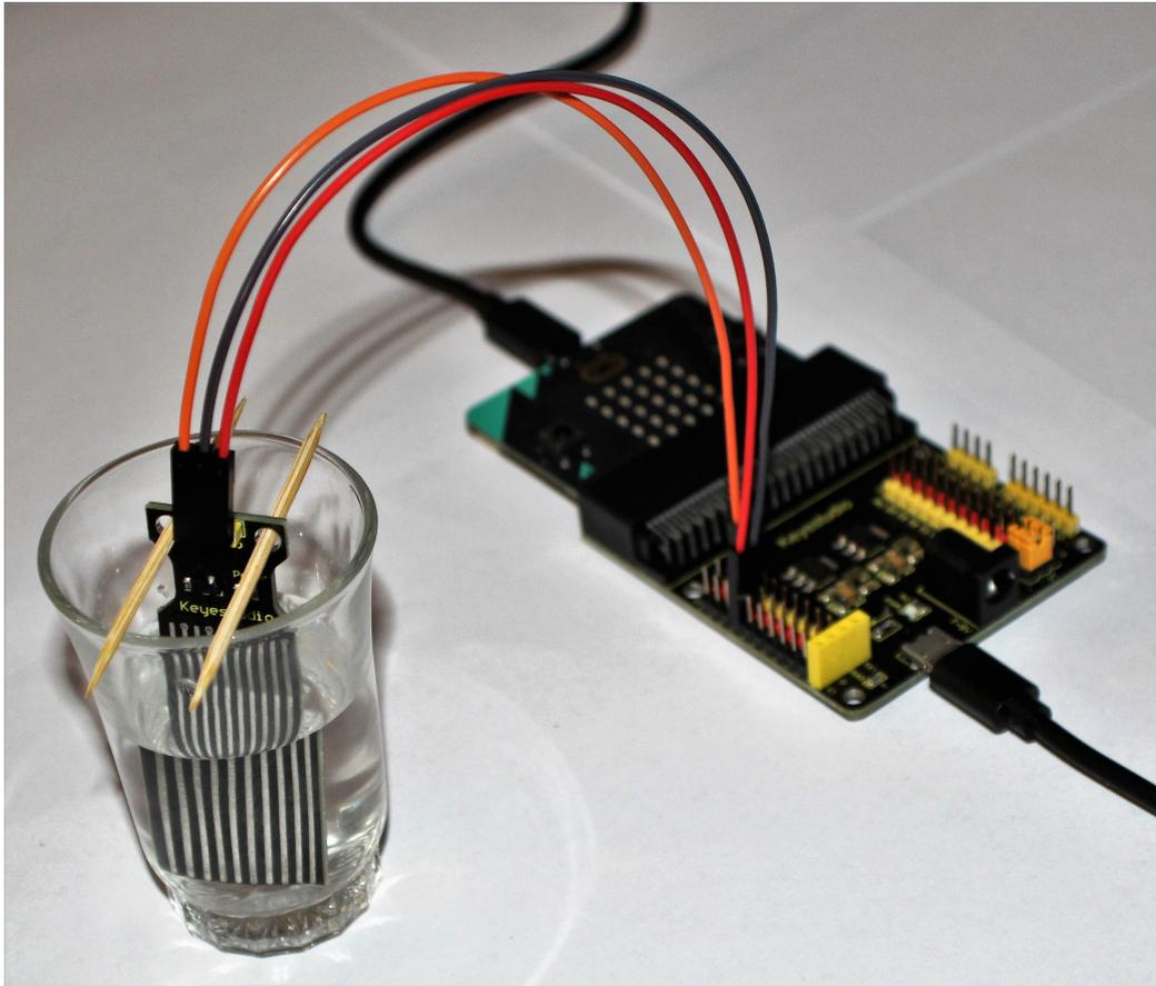
Slika 3.2: Mjerni postav za mjerenje volumena tijela
