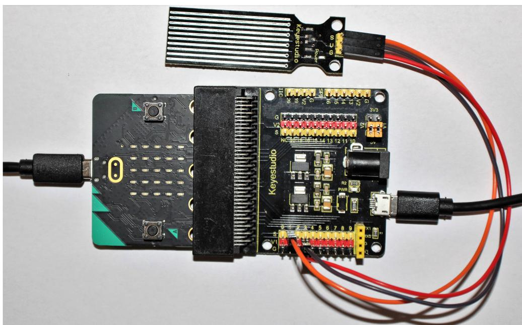
Slika 3.1: Mjerni uređaj za mjerenje volumena tijela
