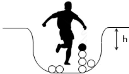
Slika 5.5: Nogometaš ispuca lopte iz jame na dubini h - analogija s elektronima u kristalnoj rešetci
