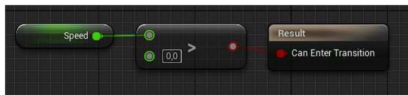
Slika 4.7: Prijelaz iz stanja Idle u stanje Run
