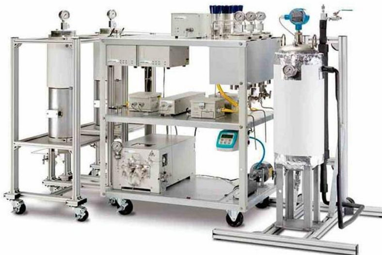
Slika 4. Uređaj za superkričnu fluidnu ekstrakciju. 8
