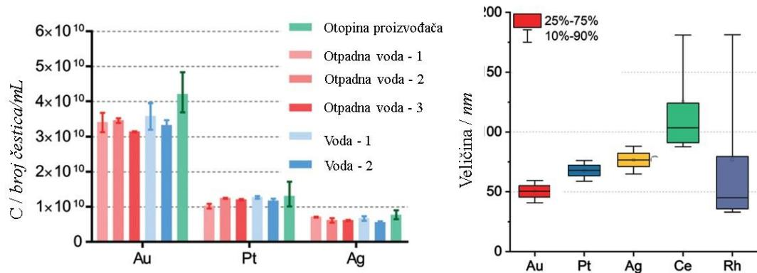
Slika 13. Rezultati određivanja broja različitih nanočestica metodom sp-ICP-TOF-MS u uzorcima voda (lijevo) te rezultati određivanja veličine nanočestica metodom sp-ICP-TOF-MS u uzorku otpadne vode. Preuzeto i prilagođeno iz literaturnog izvora<sup>48</sup>.
