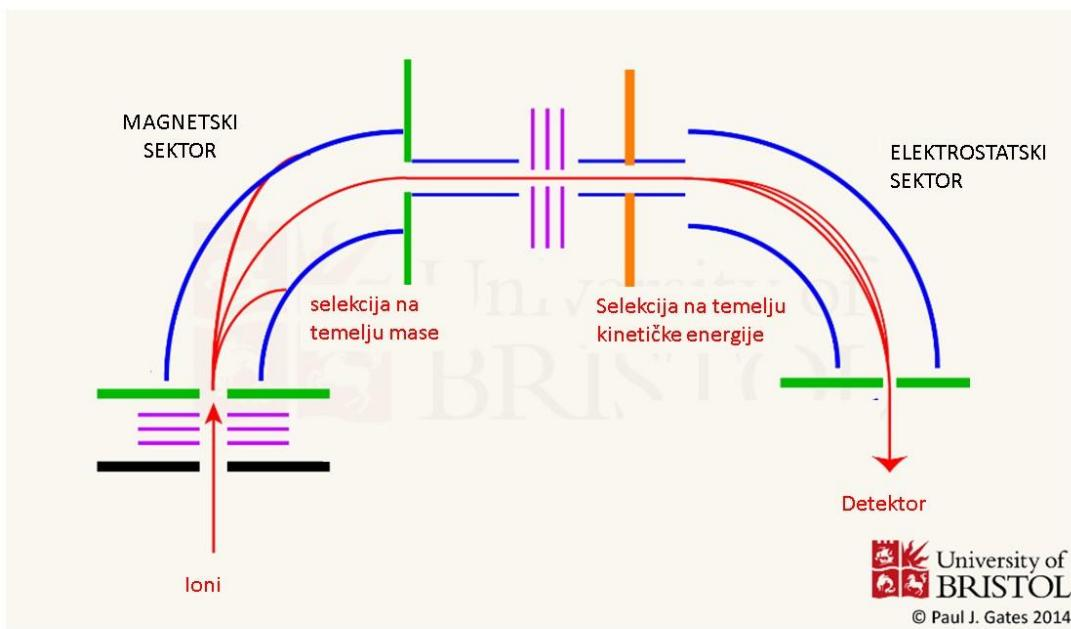
Slika 10. Shema rada sektorskog analizatora masa. Preuzeto i prilagođeno iz literaturnog izvora<sup>43</sup>.
