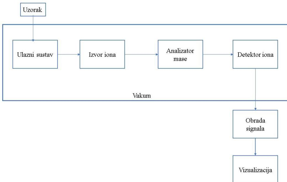
Slika 4. Osnovni dijelovi spektrometra masa. Preuzeto i prilagođeno iz literturnog izvora<sup>19</sup>.
