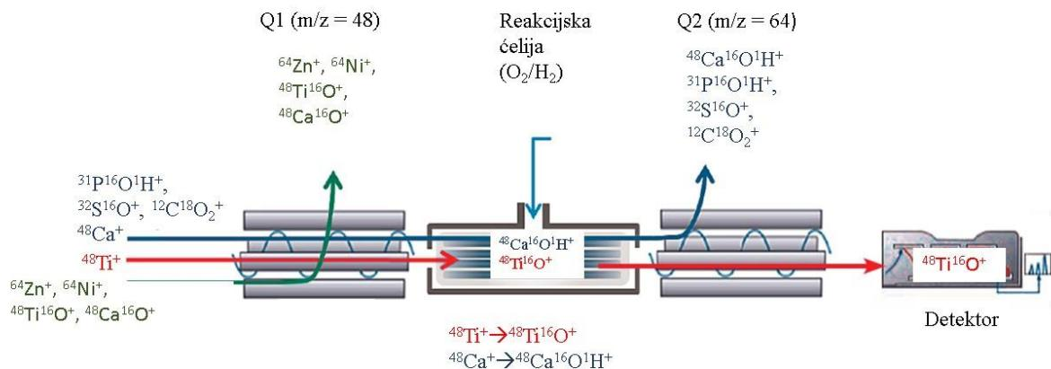
Slika 9. Određivanje  $^{48}\text{Ti}^+$  u obliku  $^{48}\text{Ti}^{16}\text{O}^+$  koristeći ICP-QQQ. Preuzeto i prilagođeno iz referenci<sup>39,40</sup>.
