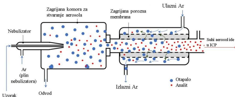
Slika 11. Načelo rada desolvatacijskog raspršivača. Preuzeto i prilagođeno iz literaturnog izvora<sup>44</sup>.
