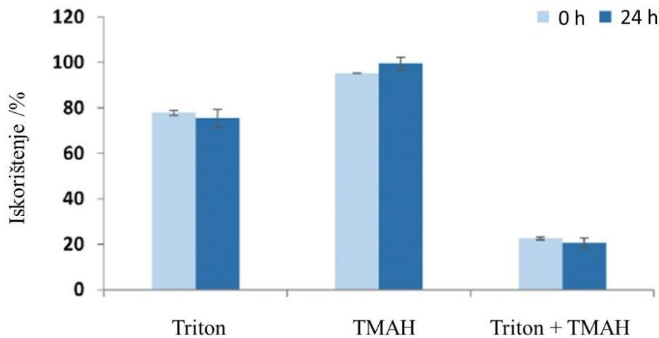
Slika 8. Utjecaj 5%-tnog TMAH i/ili 0,1%-tni Triton X na stabilizaciju nanočestica platine.
