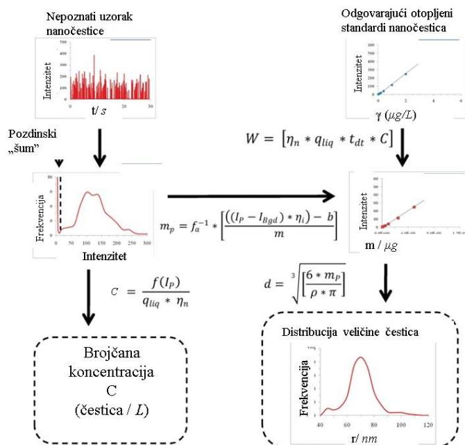
$f(I_p)$  - frekcencija pulsa,  $q_{liq}$  - brzina protoka uzorka,  $\eta_n$  - učinkovitost prijenosa,  $m_p$  - masa čestice,  $I_p$  - intenzitet individualnog pulsa,  $I_{Bgd}$  - prosječni pozadinski signal,  $\eta_i$  - efikasnost ionizacije,  $f_a^{-1}$  - maseni udio čestice,  $C$  – broj čestica/L
