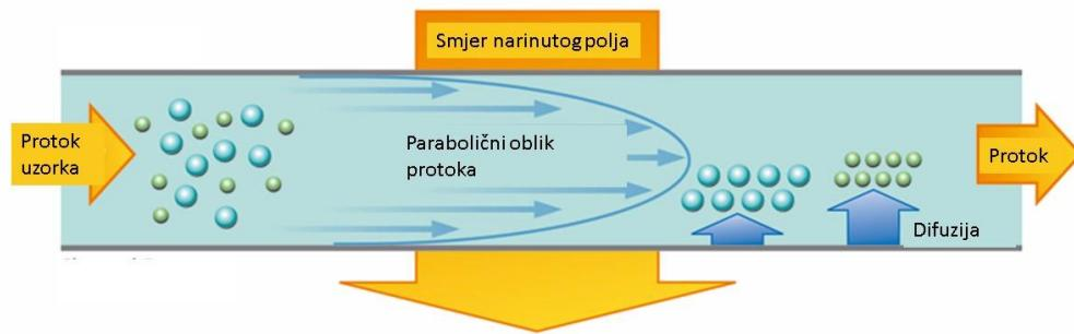
Slika 15. Shematski prikaz načela metode frakcioniranja uzorka na temelju narinutog polja.
