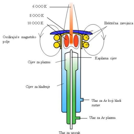
Slika 5. Shematski prikaz nastajanja induktivno spregnute plazme. Preuzeto i prilagođeno iz literaturnog izvora<sup>20</sup>.
