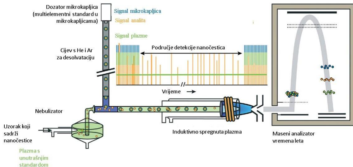
Slika 12. Shematski prikaz sp-ICP-TOF-MS uređaja s dva ulaza: jedan za uzorak s nanočesticama, a drugi za standard s mikrokapljicama. Preuzeto i prilagođeno iz literaturnog izvora<sup>48</sup>.
