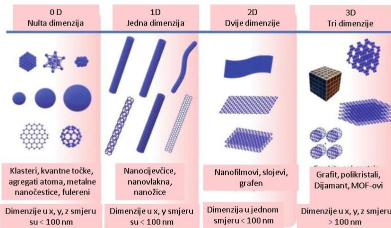
Slika 2. Podjela nanočestica prema različitim dimenzijama u smjeru osi (x, y, z) u rasponu od 1 do 100 nm. Preuzeto i prilagođeno iz literturnog izvora<sup>7</sup>.
