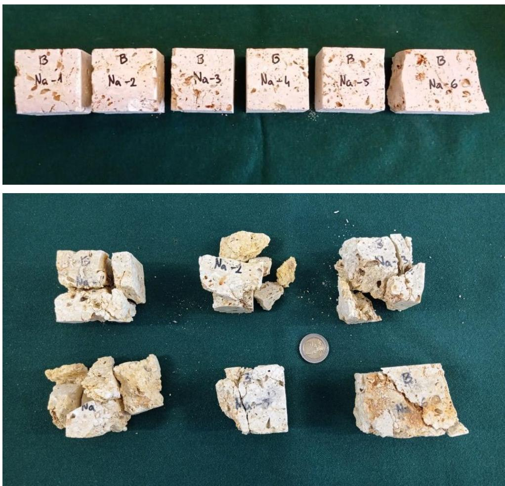
Slika 11. Uzorci litotamnijskog vapnenca prije (slika gore) i nakon ispitivanja postojanosti upotrebom natrijevog sulfata (slika dolje)
