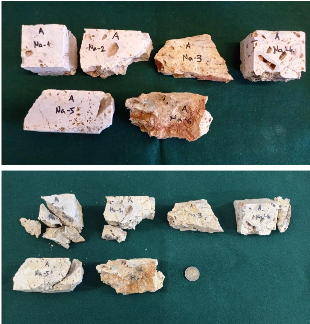
Slika 10. Uzorci litavca prije (slika gore) i nakon ispitivanja postojanosti upotrebom natrijevog sulfata (slika dolje).
