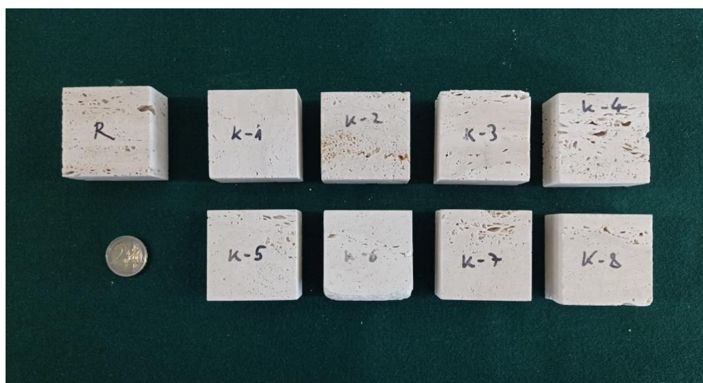
Slika 6. Uzorci travertina nakon 15 ciklusa ispitivanja otpornosti na kristalizaciju soli
