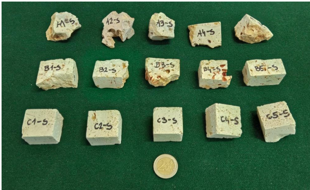
Slika 14. Uzorci litavca (prvi red, oznaka A), litotamnijskog vapnenca (drugi red, oznaka B) i travertina (treći red, oznaka C) nakon 5 ciklusa ispitivanja Slake durability test -om u otopini sumporne kiseline (s).
