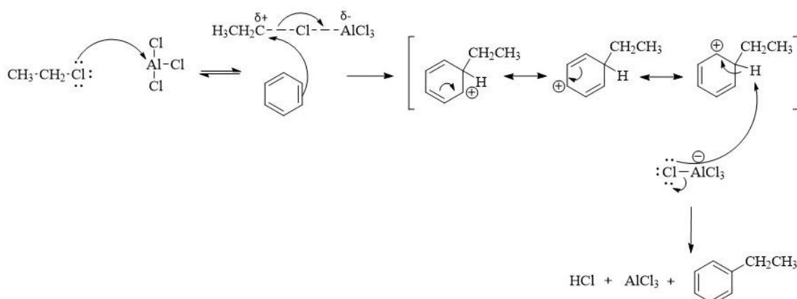
Slika 6. Mehanizam Friedel-Craftsovog alkiliranja benzena u reakciji primarnog halogenalkana i  $\text{AlCl}_3$  kao katalizatora
