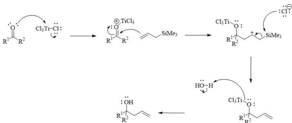
Slika 16. Mehanizam Hosomi-Sakurai reakcije katalizirane Lewisovom kiselinom  $\text{TiCl}_4$
