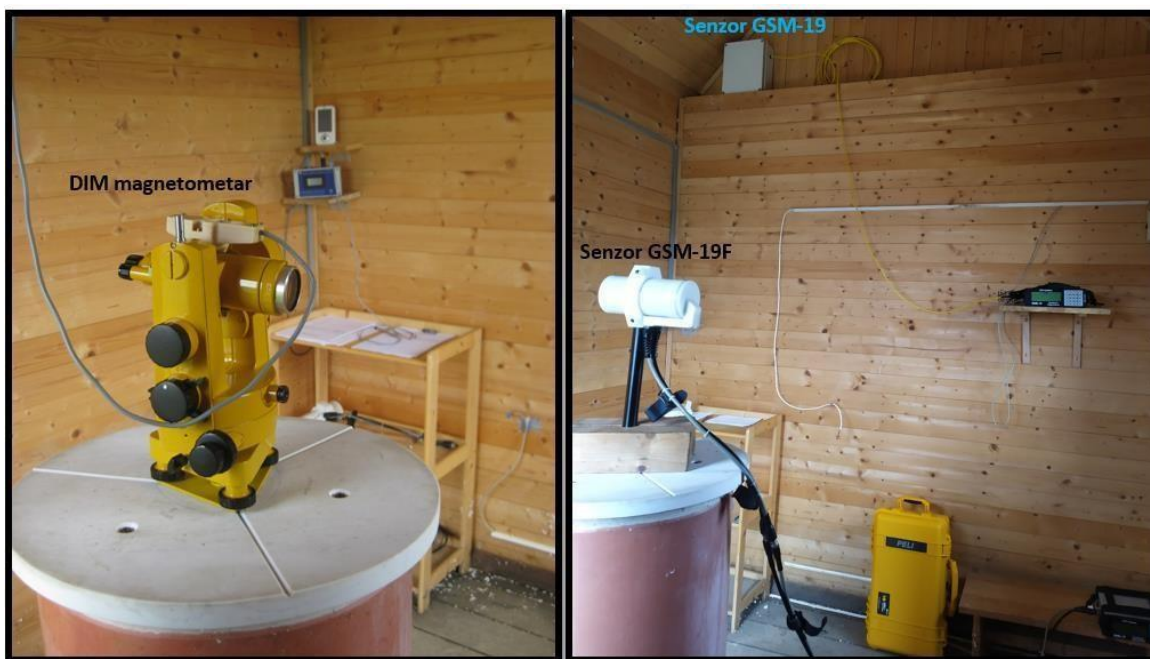
Slika 1.5 – Lijevo: Deklinacijsko-Inklinacijski magnetometar na pilaru u A kući. Desno: Mjerenja totalnog intenziteta F u A kući. Senzor GSM-19 magnetometra (u plastičnoj kutiji) permanentno mjeri F na udaljenosti od 2,5 metra od A pilara. Senzor GSM-19F magnetometra koji povremeno mjeri na referentnom A pillaru.
