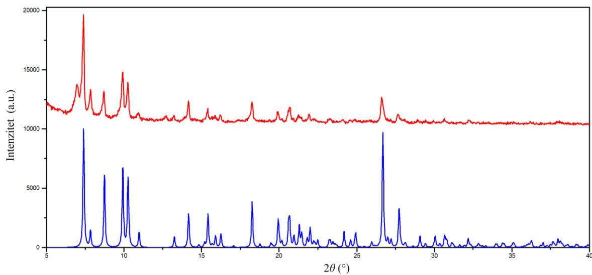
**Slika D7.** Usporedba eksperimentalnog difraktograma spoja **1c·2H<sub>2</sub>O·CH<sub>3</sub>OH** dobivenog mehanokemijskom sintezom korištenjem bezvodnog bakrova(II) sulfata (crvena linija) i izračunatog difraktograma na temelju kristalne strukture (plava linija) (detalji sinteze prikazani u tablici 9).
