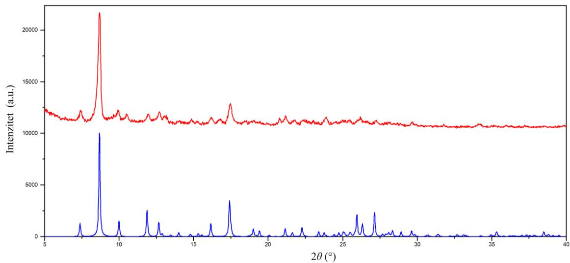
**Slika D8.** Usporedba eksperimentalnog difraktograma spoja **1d·H<sub>2</sub>O** dobivenog u smjesi s nepoznatom fazom mehanokemijskom sintezom (crvena linija) i izračunatog difraktograma na temelju kristalne strukture (plava linija) (detalji sinteze prikazani u tablici 8).
