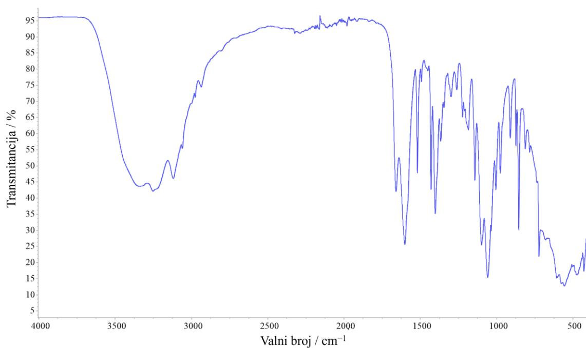
Slika D9. IR spektar spoja **1a·10H<sub>2</sub>O**.
