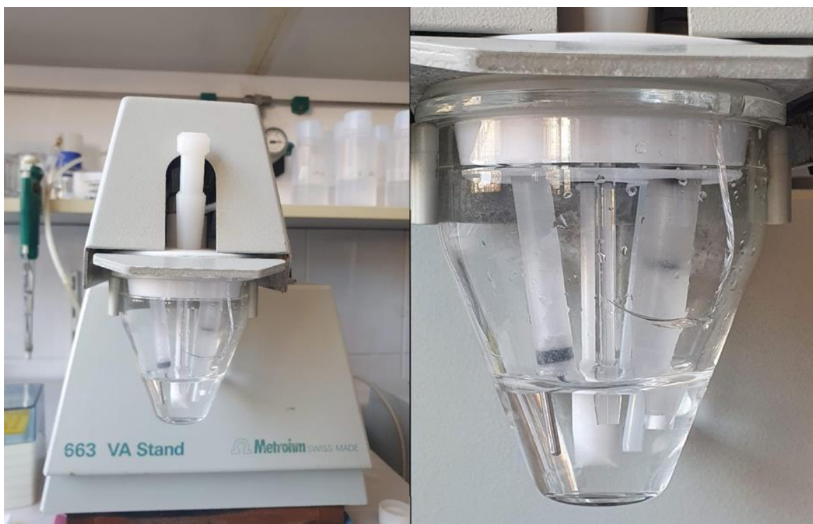
Slika 4.6-3: troelektrodni sustav proizvođača Metrohm®, model 663 VA Stand, koji se sastoji od elektrokemijske staklene ćelije, radne elektrode, protuelektrode, referentne elektrode, miješalice i puhalice za dovod dušika (Fotografirao: Ivan Lakuš)
