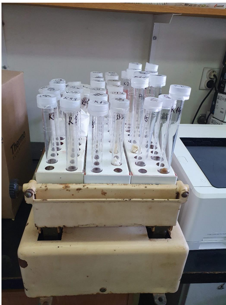
Slika 4.6-1: Zakiseljeni uzorci u kivetama na linearnoj tresilici (Fotografirao: Ivan Lakuš)
