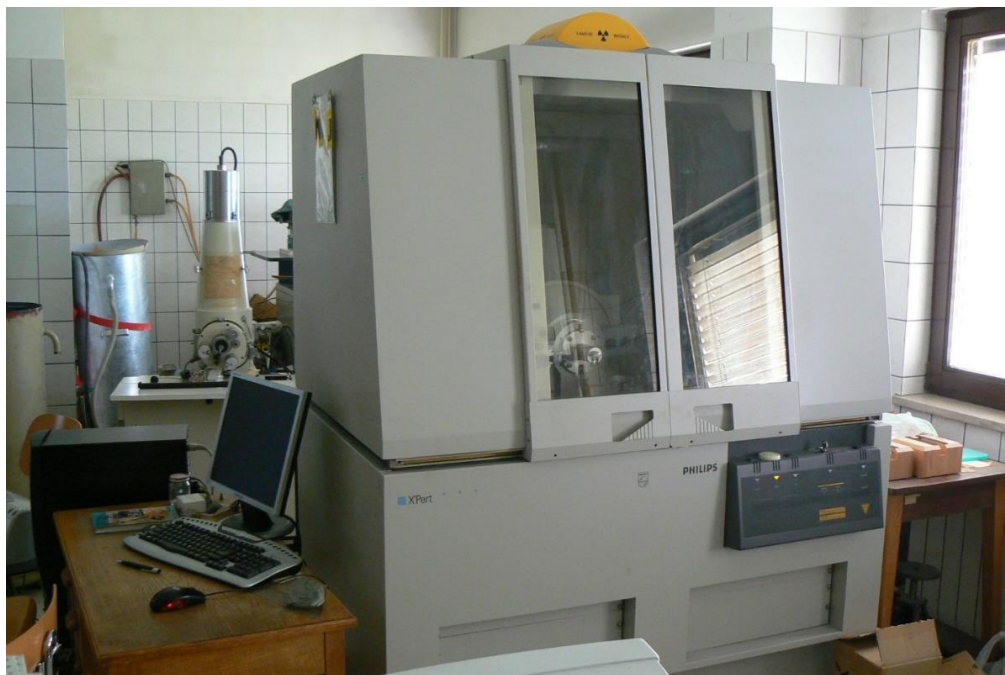
Slika 4.4-1: Rendgenski difraktometar za prah Philips PW 3040/60 X'Pert Pro® (Fotografirala: Kristina Pikelj)
