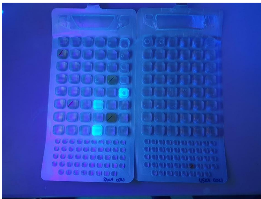
Slika 4.7-6: Promatranje fluorescencije (bazečiči koji fluoresciraju potvrđeno su pozitivni na E. coli) na Quantitray2000® pladnjevima prilikom Colilert-18® testiranja (Fotografirao: Ivan Lakuš)
