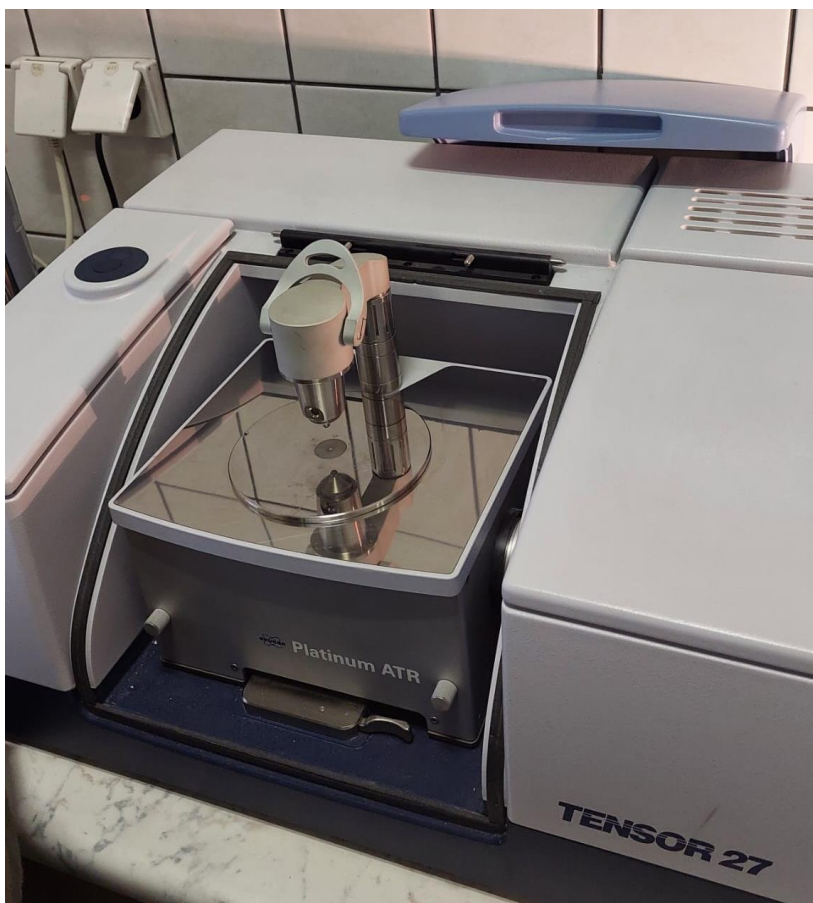
Slika 4.5-3: Spektrometar proizvođača Bruker, model Tensor 27 (Fotografirao: Vito Stančec)
