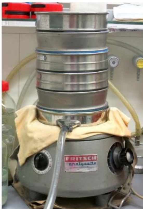
Slika 4.2-1 Retsch® ASTM sita sita od nehrđajućeg čelika različitih veličina promjera otvora posloženi na mehaničkoj tresilici Fritsch Analysette® (Fotografirao: Ivan Lakuš)
