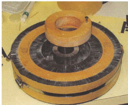
Slika 9b. Limovi povezani ljepilom
