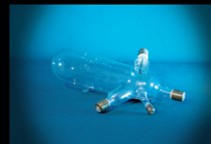
Gaedeov molvakuummetar, zaštitni ventil, 1938.
