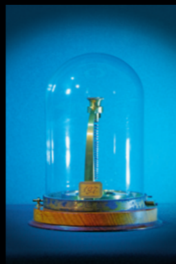
Kovni termometar po Breguetu 30. 4. 1877.
