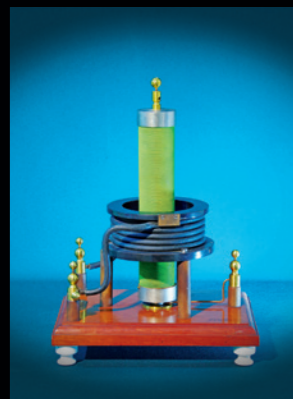
Transformator za visoke napetosti s 2 uzvojnice 7. 3. 1905.
