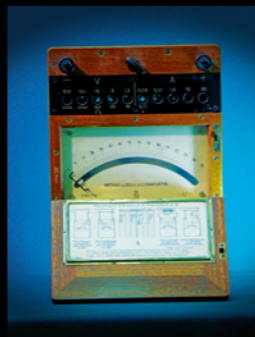
Univerzalni instrument s pokretnim okvirom 30. 3. 1927.
