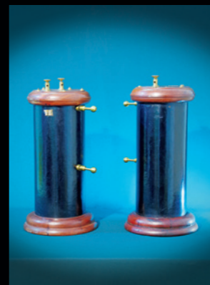
Dvostruki induktor duljina iskre 15 cm 4. 3. 1905.
