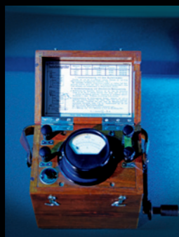
Ispitivač izolacije s induktorom, 1927.
