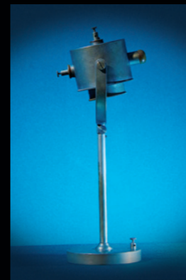
Fotoelektrički aparat po Elster und Geitelu 1. 1. 1897.
