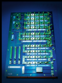
Sprava za mjerenje kapaciteta i samoindukcija 10. 2. 1916.
