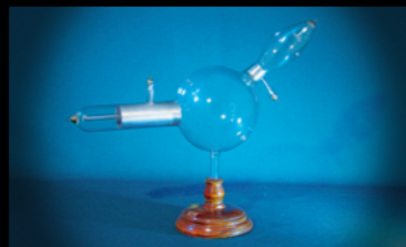
Cijev po Perrinu za pokazivanje negativnog naboja katodnih zraka 16. 11. 1911.
