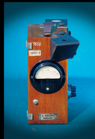
Univerzalni fotometar po Voegu s pripacima 25. 3. 1932.
