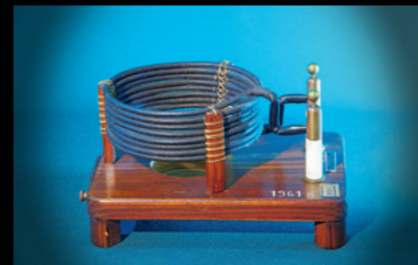
Teslin transformator s uzvojnicom za ugađanje, 1940.
