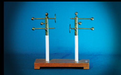
Sprava sa 2 iskrišta, šiljak-ploča 1933.
