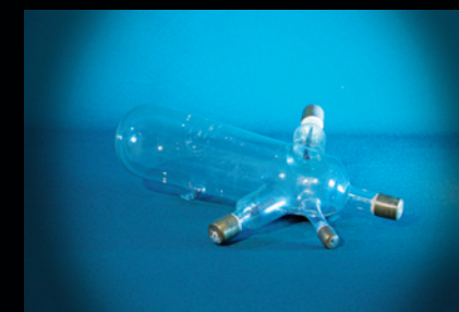
Gaedeov molvakuummetar, zaštitni ventil, 1938.
