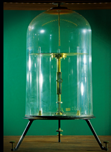
Long range – elektrometar po Thomsonu, 1889.
