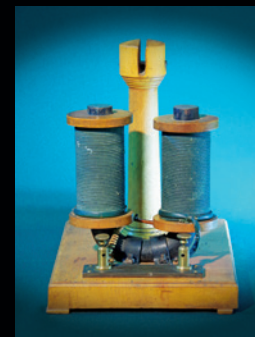
Spojene zavojnice sa željeznom jezgrom 1933.
