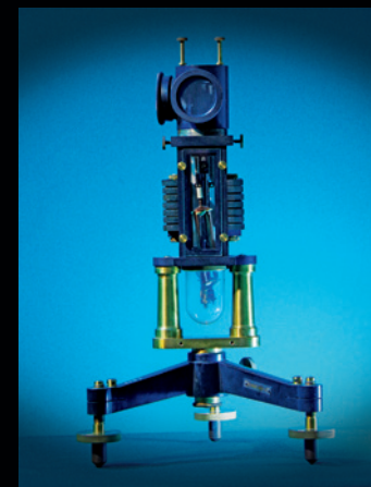
Galvanometar s pomičnom uzvojnicom 12. 1. 1911.
