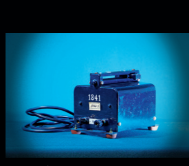
Transformator s pomicaljkom s rastavljenim uzvojnica ruhstrat „tg“ 5. 1937.
