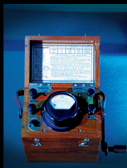
Ispitivač izolacije s induktorom, 1927.
