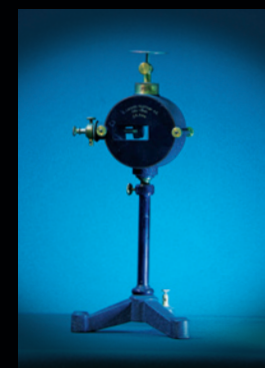
Univerzalni elektroskop po Wulfu 15. 1. 1926.
