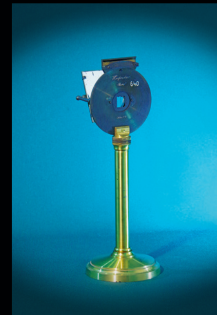
Prozirna ljestvica za galvanometar 4. 3. 1889.
