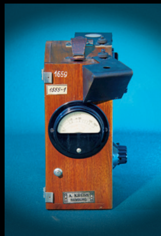
Univerzalni fotometar po Voegu s pripacima 25. 3. 1932.
