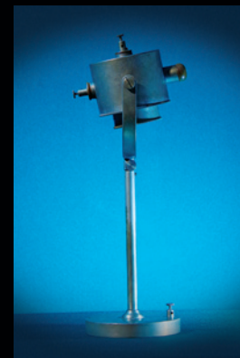
Fotoelektrički aparat po Elster und Geitelu 1. 1. 1897.
