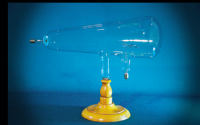
Crookesova cijev s križem 1931.
