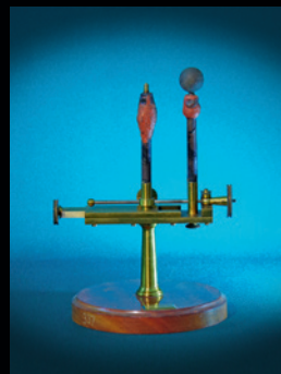
Mikrometar za iskre po Riese 24. 1. 1878.
