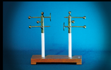
Sprava sa 2 iskrišta, šiljak-ploča 1933.
