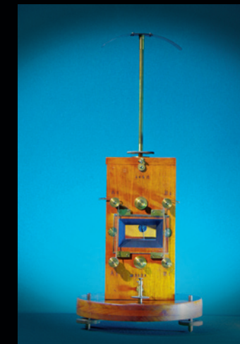
Vaga na pero za magnetičke pokuse 1. 4. 1890.
