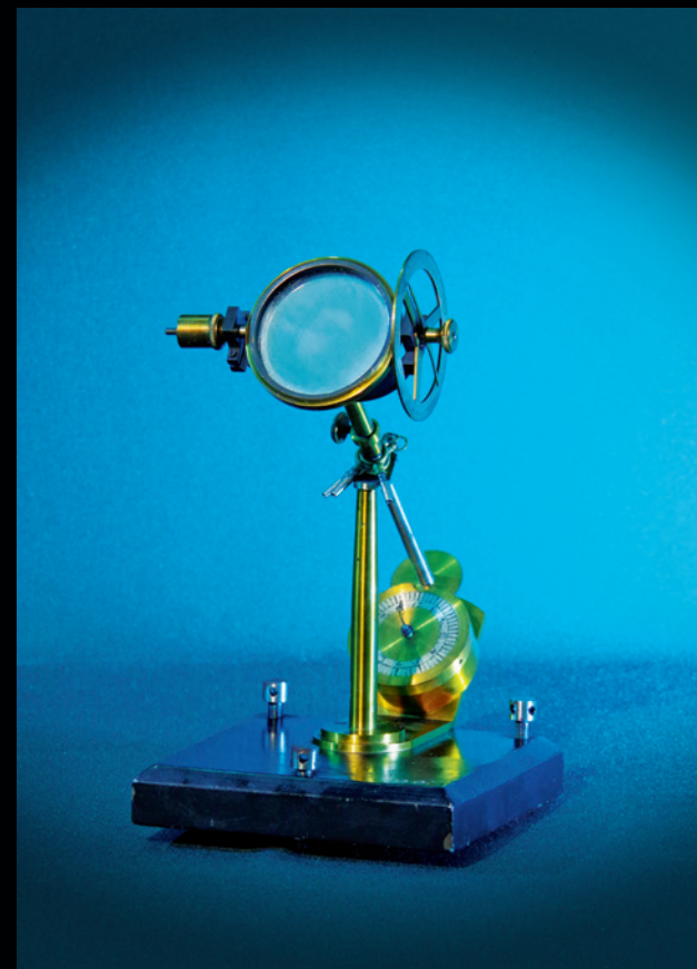
Heliostat sa 2 pomoćna zrcala 23. 9. 1876.
