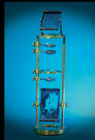
Polarizaciona sprava za paralelno svijetlo 29. 3. 1876.
