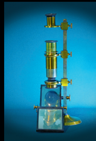
Polarizaciona sprava s velikim vidnim poljem 39. 3. 1876.
