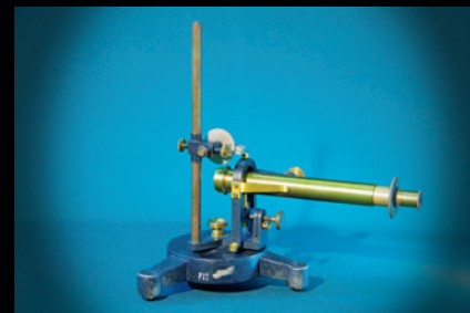
Dalekozor za očitavanje 23 mm 25. 1. 1892.
