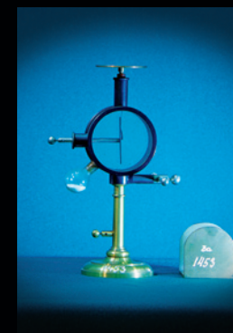
Elektroskop po Zeleny za pokuse o radioaktivnosti i jonizaciji 15. 1. 1926.
