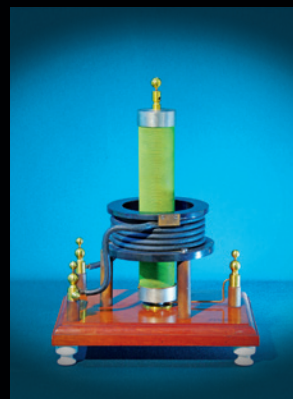
Transformator za visoke napetosti s 2 uzvojnice 7. 3. 1905.
