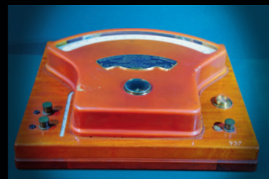
„Laboratorium normal mili-voltmeter” 27. 2. 1900.
