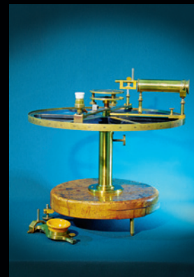
Goniometar po Noacku i magnetometar sa šipkastim magnetom 27. 4. 1895.
