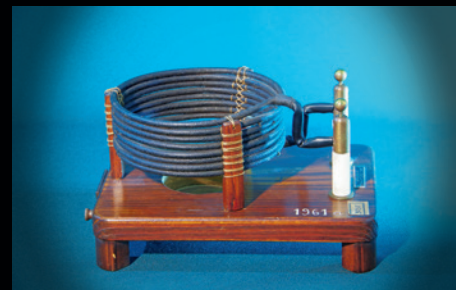
Teslin transformator s uzvojnicom za ugađanje, 1940.
