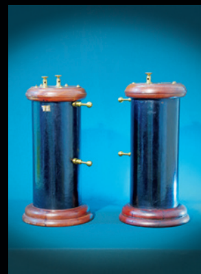
Dvostruki induktor duljina iskre 15 cm 4. 3. 1905.
