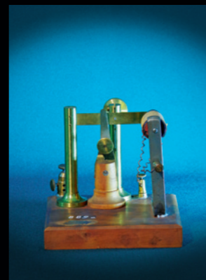
Interruptor za Ruhmkorffov induktor s tankim šipkama od platine 24. 5. 1897.
