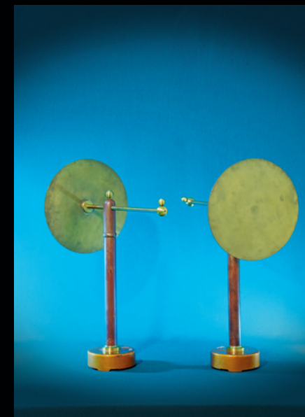
2 kotača od 24 cm za oscilator po Hertzu 8. 5. 1896.
