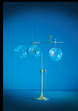
Radiometri za zvuk koji s rastućom snagom zvuka obustave rotaciju 22. 1. 1896.
