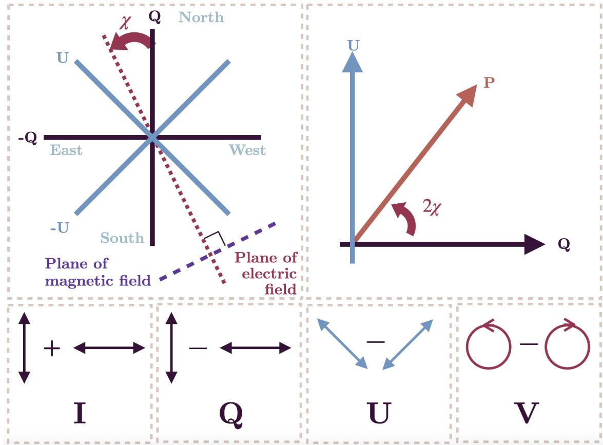
Slika A.1: Shema prikazuje odnos Stokesovih parametara i vektora polarizacije s kutom polarizacije  $\chi$ . Od vrha slike u smjeru kazaljke na satu, Q-osi redom odgovaraju oznakama sjevera, zapada, juga i istoka na kompasu. Izvor: Emma L. Alexander<sup>13</sup>
