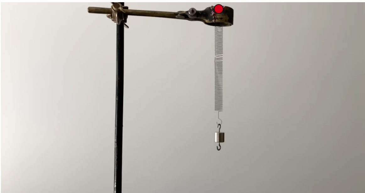
Slika 5.2: Eksperimentalni postav mase na opruzi s označenim ovjesištem
