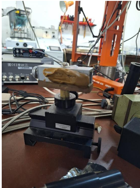
Slika 24 Postolje na koje se stavlja uzorak. Uzorak stakla se prilijepe na komadić gline.
