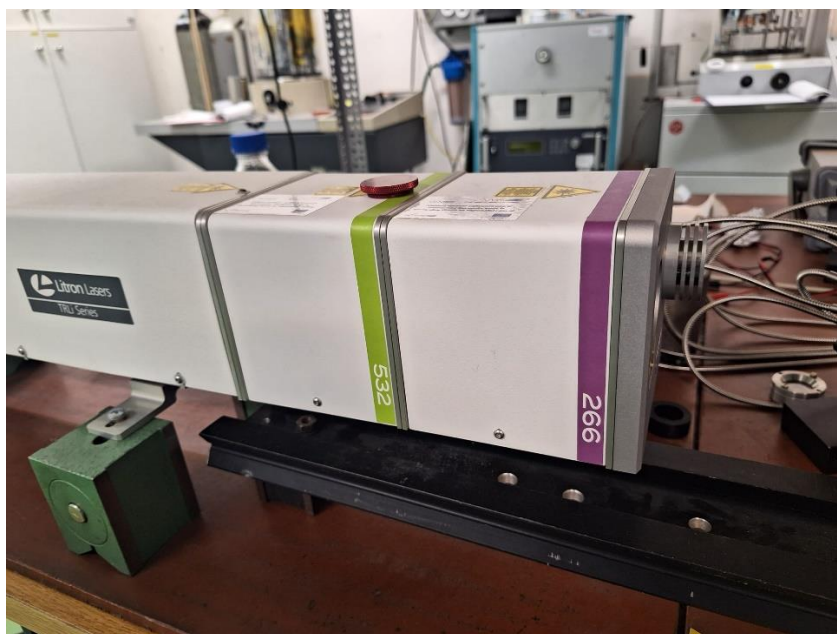
Slika 23 Glava Litron TRLi G 450-10 1064nm Q-switched Nd:YAG lasera s dva HG modula.
