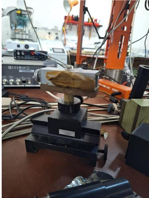
*Slika 24 Postolje na koje se stavlja uzorak. Uzorak stakla se prilijepi na komadić gline.*
