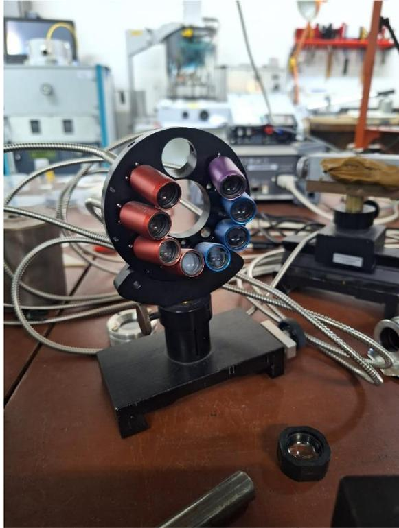
*Slika 25 Korišteni detektori i optički kabeli.*
