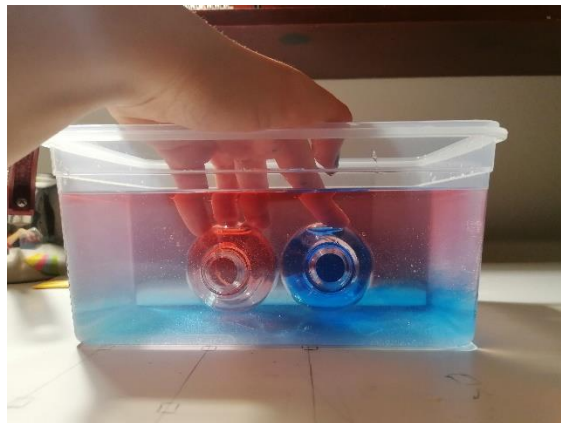
Slika 4.23 Slana voda obojana u plavo ide na dno, dok obična voda ostaje na istoj visini ili ide na vrh
