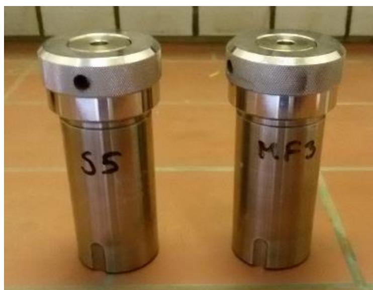
Slika 10. Čelični plaštevi (autoklavi) korišteni u disertaciji za sintezu uzorka
