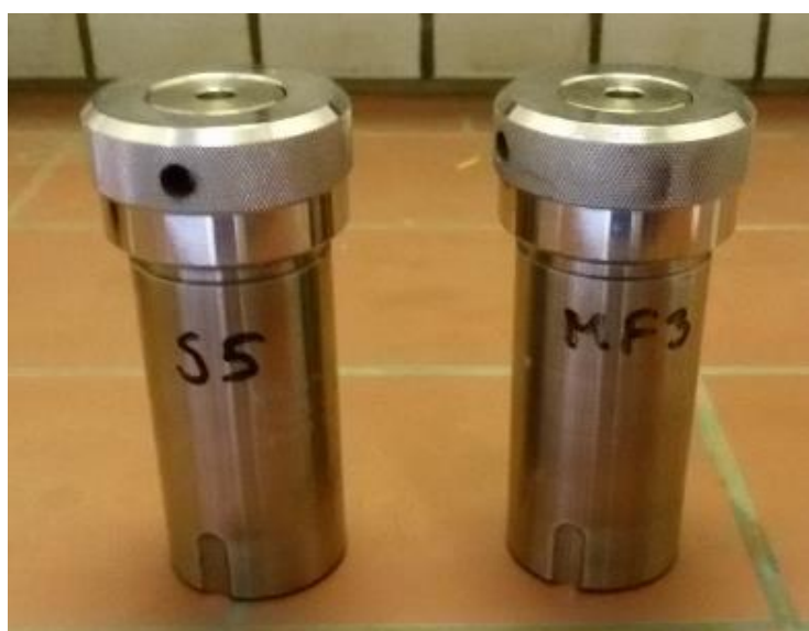
Slika 10. Čelični plaševi (autoklavi) korišteni u disertaciji za sintezu uzoraka
