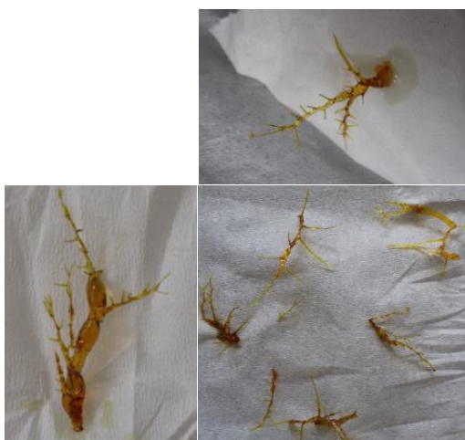
Slika 8. Stvrdnute 'grančice' polimerne otopine s vrha igle nakon elektroispredanja razgranate su zbog pojavljivanja više Taylorovih konusa, odnosno zbog višemlaznog elektroispredanja
