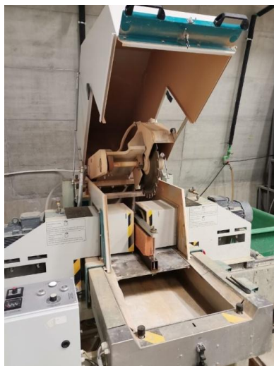
Slika 25. Uređaj za brušenje i ravnanje površine opeka Infratest.
