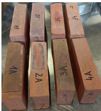
Slika 19. Glinene opeke kompozitnih smjesa 1A – 4A (2,5 % TiO 2 R050 + 2,5 % ATO) i 1F – 4F (2,5 % TiO 2 R050 + 2,5 % lebdećeg pepela) nakon termičke obrade.
