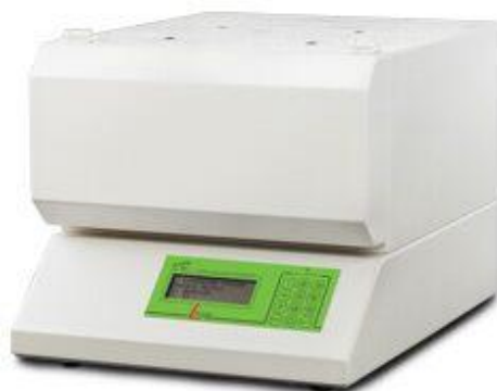
Slika 24. Instrument za mjerenje toplinske vodljivosti FOX 200 (TA Instruments). 68
