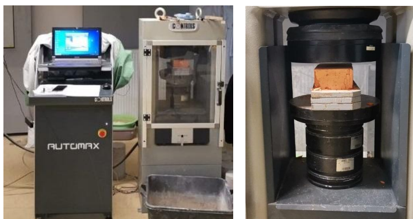
Slika 26. Hidraulična preša za određivanje tlačne čvrstoće.
