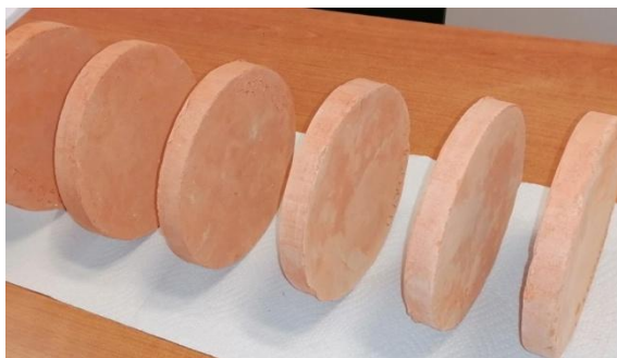
Slika 17. Kompozitni glineni diskovi promjera 15 cm nakon termičke obrade pripremljeni za daljnja ispitivanja.
