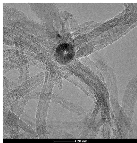
Slika 32. Mikrofotografija višestjenčanih uljikovih nanocjevčica (MWCNT) snimljena transmisijskom elektronskom mikroskopijom (TEM).
