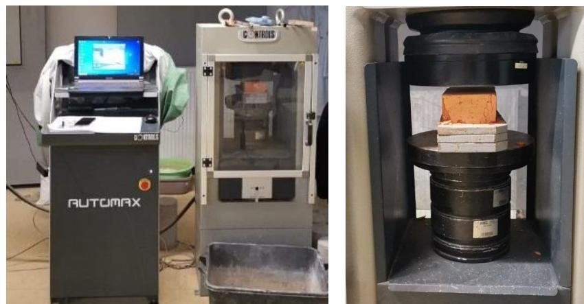
Slika 26. Hidraulična preša za određivanje tlačne čvrstoće.
