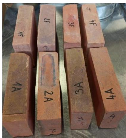
Slika 19. Glinene opeke kompozitnih smjesa 1A – 4A (2,5 %  $\text{TiO}_2 \text{ R050} + 2,5 \%$  ATO) i 1F – 4F (2,5 %  $\text{TiO}_2 \text{ R050} + 2,5 \%$  lebdećeg pepela) nakon termičke obrade.
