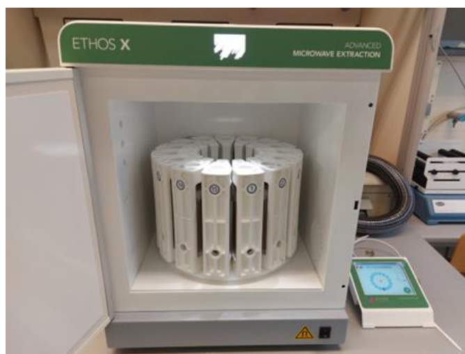
SLIKA 8. Uređaj za mikrovalno potpomognuto razaranje uzoraka.
