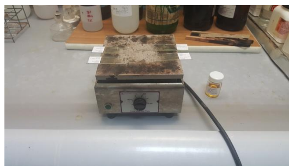
Slika 15. Uklapanje uzoraka u Naphrax smolu (autor: Mirela Šušnjara).
