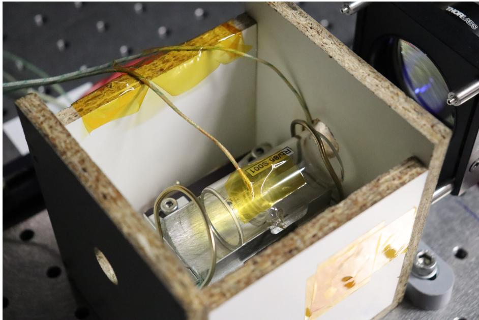
Slika 3.4: Ćelija s atomima rubidija postavljena na grijач unutar drvenog kućišta. Na stijenkama ćelije, rubovima grijaća i unutar kućišta postavljene su temperaturne sonde.
