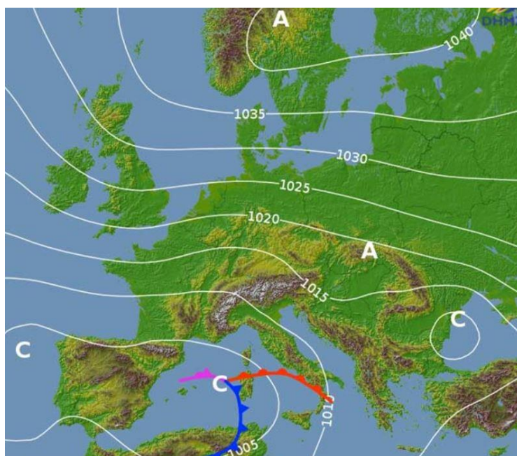
Slika 8. Sinoptička karta nastala prognozom vremena sinoptičkom metodom. Na karti su vidljive bijele krivulje izobare s odgovarajućim slovima središta ciklona (C), odnosno anticiklona (A). Hladne i tople fronte prikazane su plavom i crvenom krivuljom. 21
