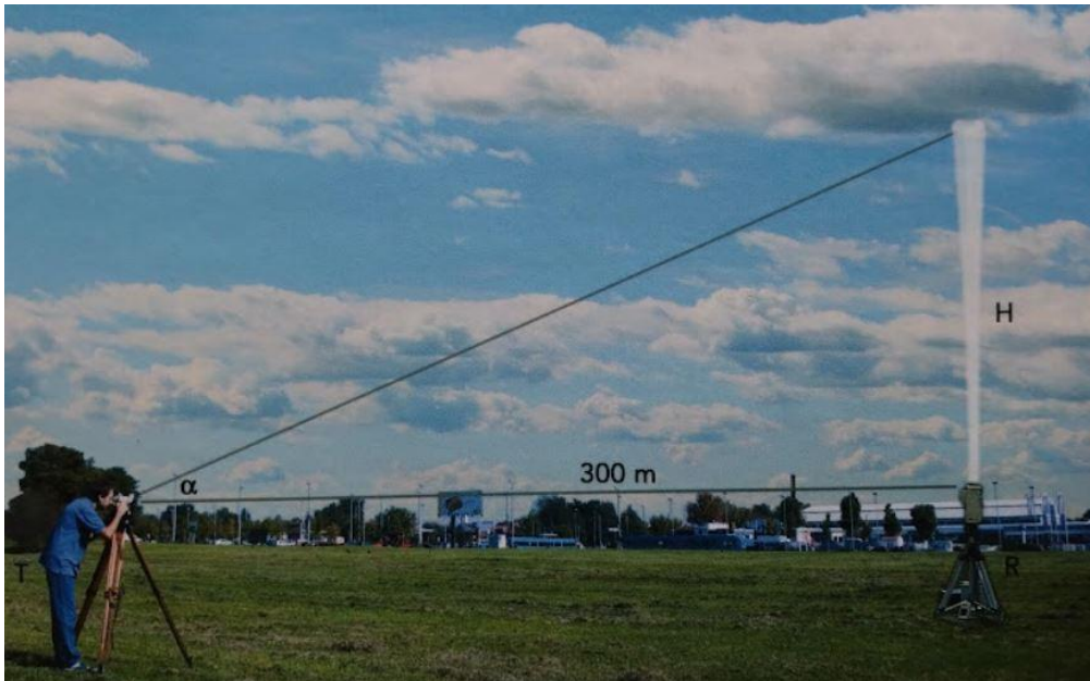
Slika 12. Prikaz mjerenja visine oblaka pomoću reflektora na položaju R gdje je H visina oblaka, \alpha kut motrenja oblaka s položaja T. 22
