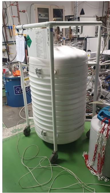
(b) Spremnik za tekući helij.
