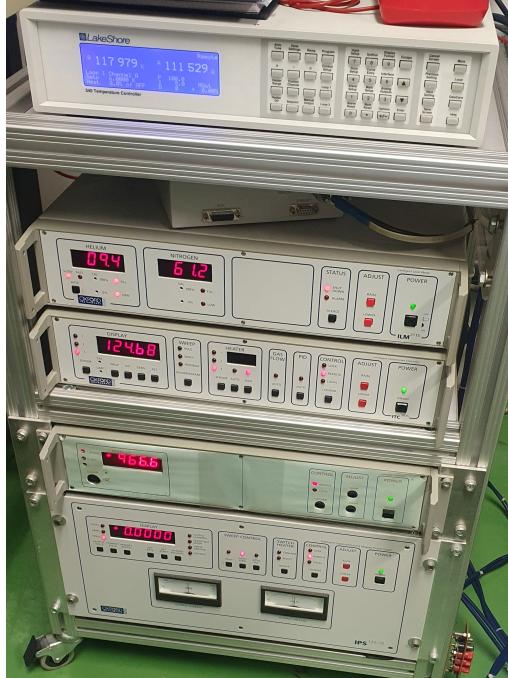
(b) Uredaj za kontrolu temperature uzorka, indikator kolicine kriogenih tekućina u kriostatu, uređaj za kontrolu VTI-a, pomoći uredaj za kontrolu VTI-a te napajanje supravodljivog magneta.
