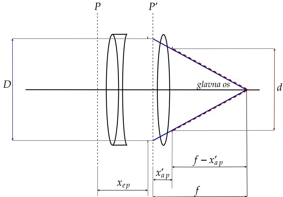
Slika 2.9: Uzvodna i izvodna pupila sustava asimetričnih leća.
