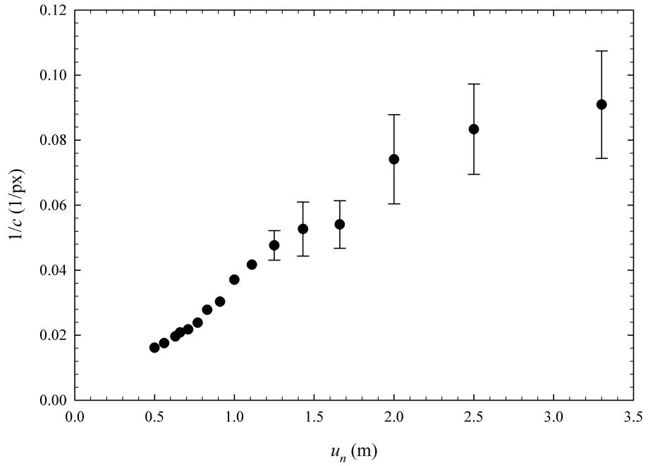
Slika 3.4: Ovisnost promjera kruga zamućenja  $1/c$  o udaljenosti predmeta  $u_n$  za fokusnu daljinu  $f = 18 \text{ mm}$ .
