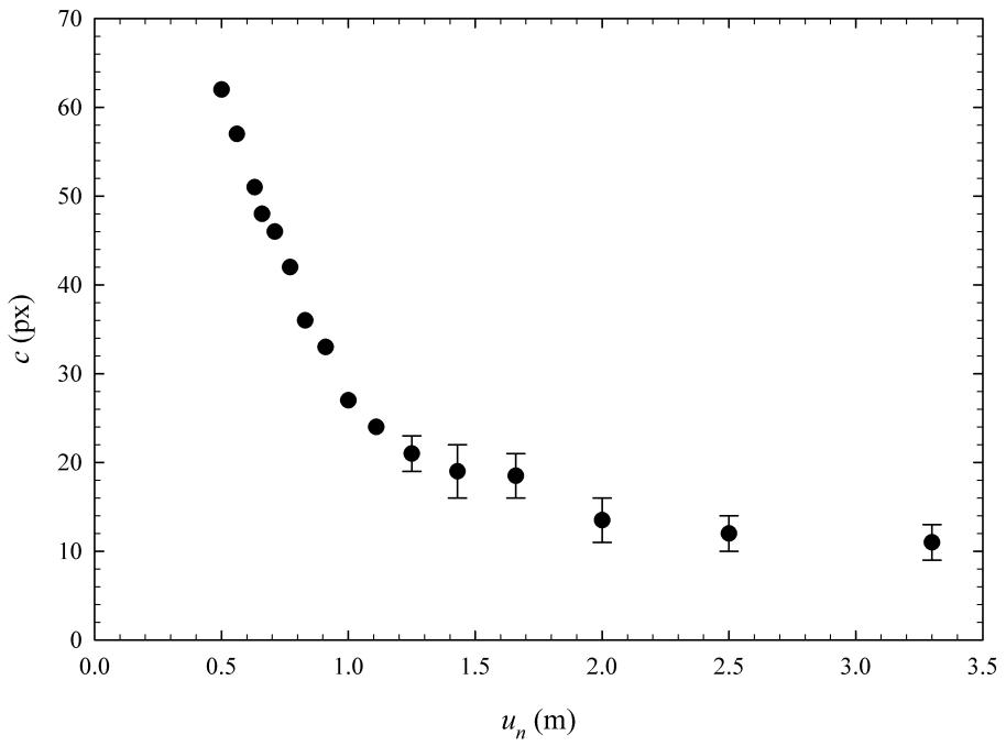
Slika 3.3: Ovisnost promjera kruga zamućenja  $c$  o udaljenosti predmeta  $u_n$  za fokusnu daljinu  $f = 18 \text{ mm}$ .
