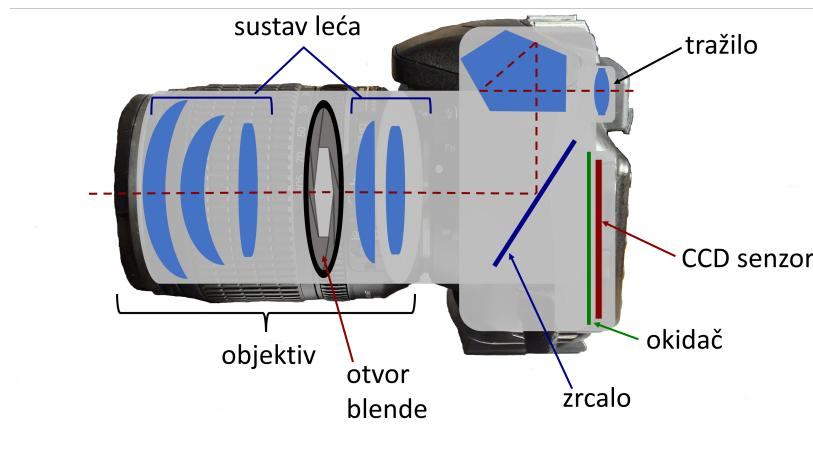
Slika 2.1: Dijelovi fotaparata.
