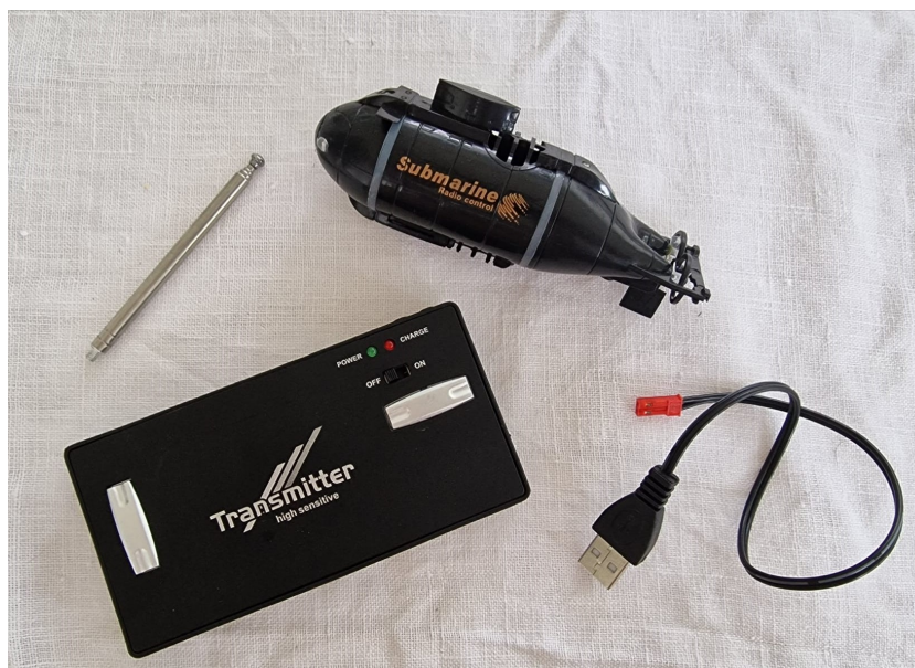
Slika 5.9: Pribor (podmornica, kontrolna kutija, antena i kabel za punjenje)
