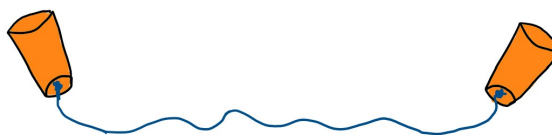
Slika 3.5: Skica jednostavnog žičanog telefona
