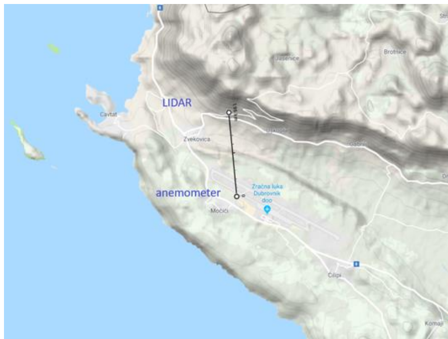
Slika 2.2. Lokacije LIDAR-a i ultrazvučnog anemometra koji su bili postavljeni u blizini zračne luke Dubrovnik u razdoblju od 8.12.2017. do 31.3.2018. (izvor: Večenaj i sur. 2020)
