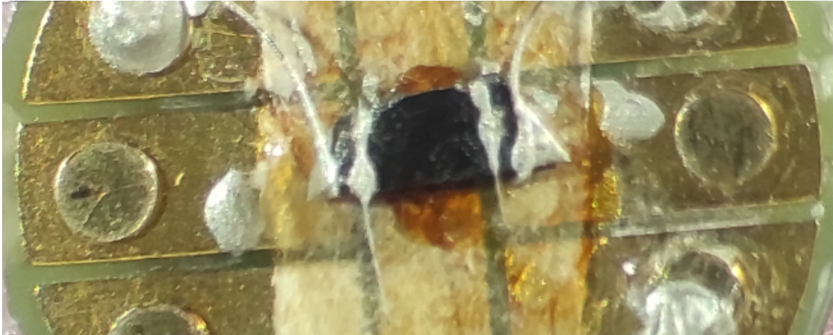
Slika 6.2: Srebrnom pastom zalijepljene su dvije srebrne žice na rubove uzorka te dvije veoma tanke platinske žice u sredini. Pomoću srebrne paste strujni kontakti prošireni su i na cijele bočne strane uzorka kako bi struja kroz uzorak bila uniformna duž poprečnog presjeka.
