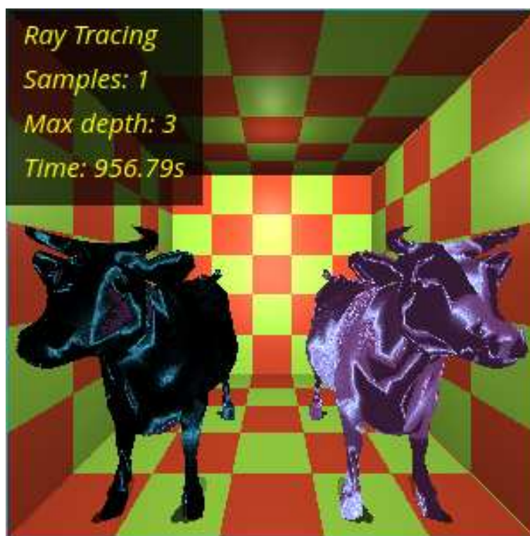
Slika 4.1: Praćenje zrake: simulacija visoko reflektirajućih površina, poput metala
