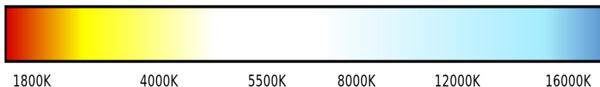
Slika 3: Maksimalne valne duljine odgovarajućeg zračenja crnog tijela određene temperature (Preuzeto sa http://www.ekorasvjeta.net/javna-rasvjeta/temperatura-svjetla/ )
