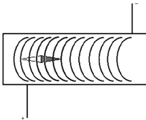
**Slika 4. Eksperiment 2: demonstracija smjera magnetskog polja u raznim točkama oko zavojnice kojom teče struja. Mali kompas je postavljen unutar zavojnice i struja je tada uključena. Učenici su mogli pomicati kompas unutar i oko zavojnice tijekom demonstracije [19]**
