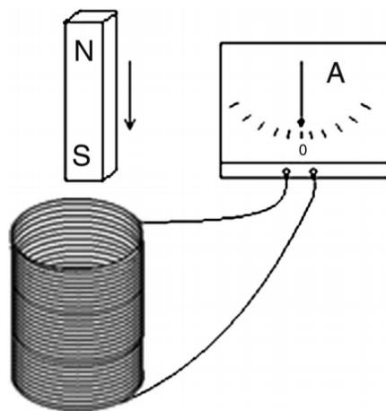
**Slika 6. Eksperiment 4: demonstriranje elektromagnetske indukcije. Magnet je umetnut u zavojnicu, ostavljen neko vrijeme u stanju mirovanja i zatim izvučen van. Učenicima je bilo dozvoljeno samostalno izvoditi eksperiment gdje su istraživali utjecaj brzine micanja magneta i različitih orijentacija magneta [19]**
