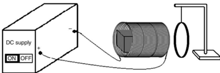
**Slika 8. Eksperiment 6:** demonstriranje Lenzovog pravila. Aluminijski prsten je ovješen tako da stoji paralelno u odnosu na zavojnicu sa željeznom jezgrom. Struja je puštena kroz zavojnicu te nakon nekog vremena prekinuta [19]
