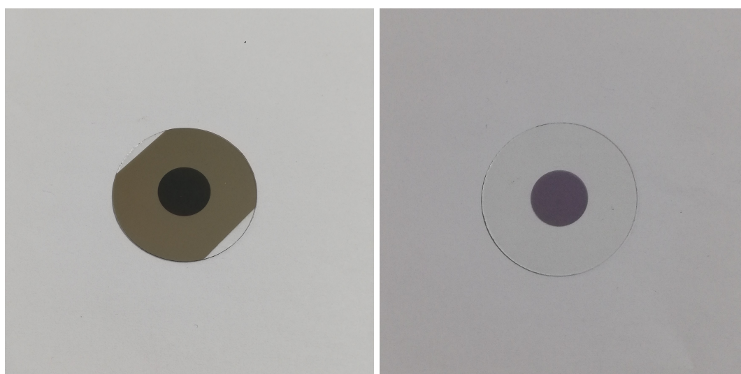
Slika 6.7: Fabricirani uzorci organskih fotokondenzatora s Cr/Au stražnjom elektrodom (lijevo) i ITO stražnjom elektrodom (desno).
