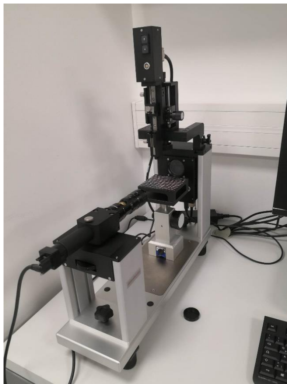
Slika 108. Goniometar korišten za mjerenje kontaktnog kuta kapljice vode na polimernim uzorcima.
