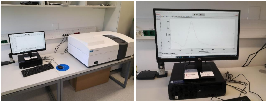
Slika 6. UV-Vis spektrofotometar i snimljeni spektar koloidnih srebrnih nanočestica dobivenih laserskom ablacijom srebrne mete sa 2000 laserskih pulseva enegije 100 mJ.
