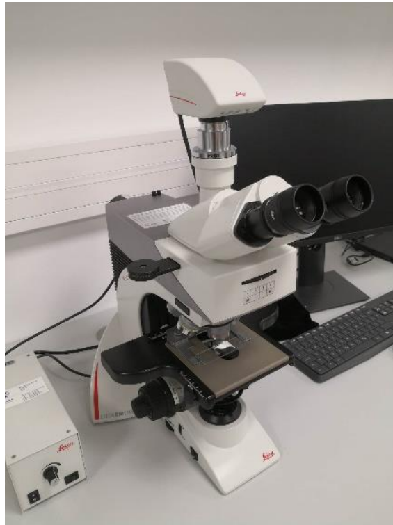
Slika 91. Optički mikroskop Leica DM2700 korišten za analizu ablatiranih kratera srebra i cink oksida.
