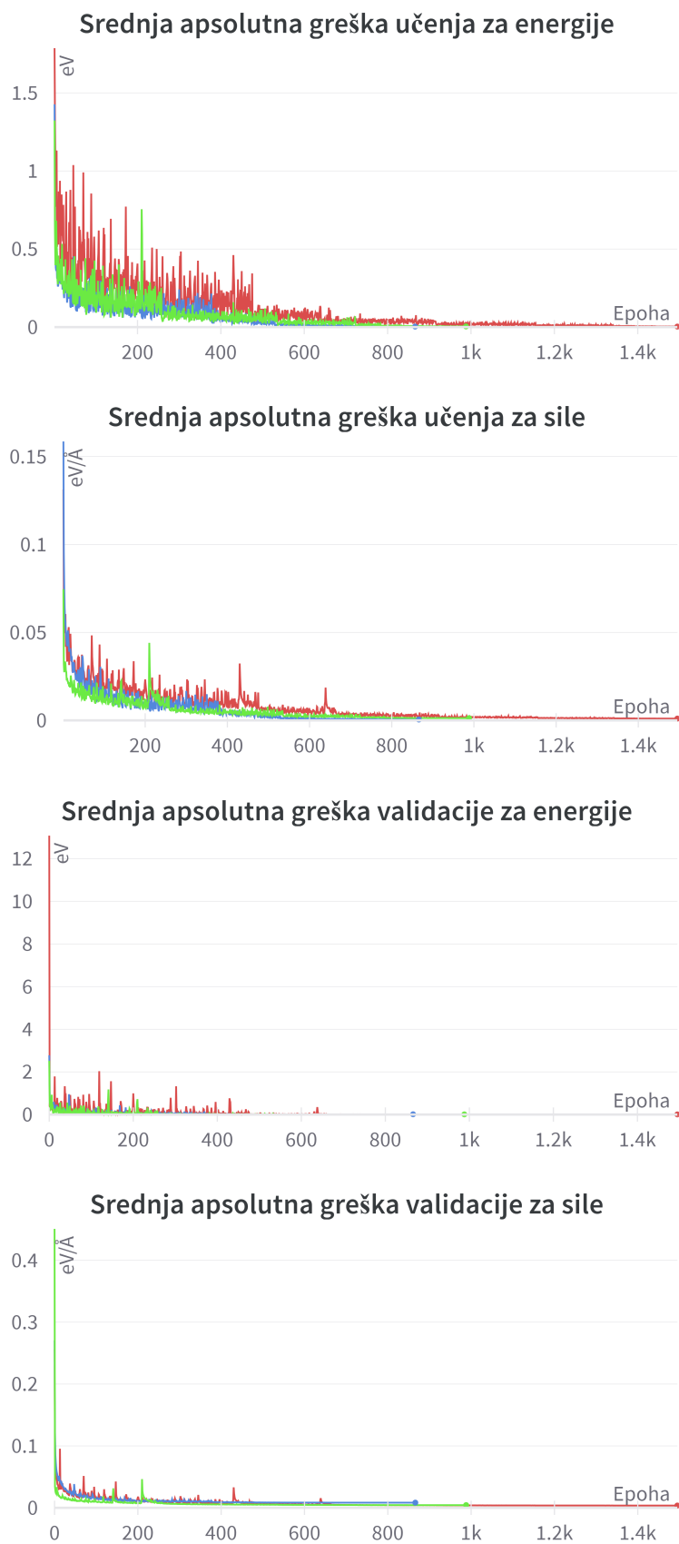
Slika 5.5: Grafovi učenja za modele učene na 1080 DFT podataka. Graf prikazuje ovisnost srednje apsolutne greške o epohi učenja za energije i sile na skupu za učenje i za validaciju. Zelenom bojom označen je model učen prijenosom s izvornim klasičnim strukturama, plavom model učen prijenosom s ARTn strukturama, a crvenom model učen samo na DFT podacima.
