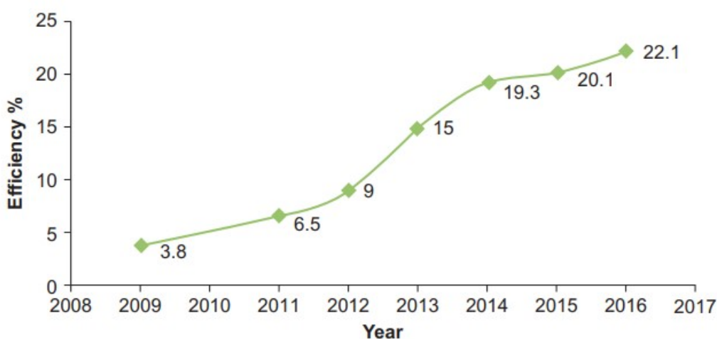
Slika 1.2: Porast učinkovitosti perovskitnih ćelija od 2009. do 2016. godine Slika preuzeta iz [8].
