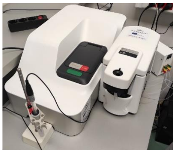
Slika 12. Prikaz instrumenta za određivanje zeta potencijala uz provođenje titracije; Malvern Zetasizer Ultra (lijevo) i Malvern Multi-purpose Titrator (MPT-3) (desno).
