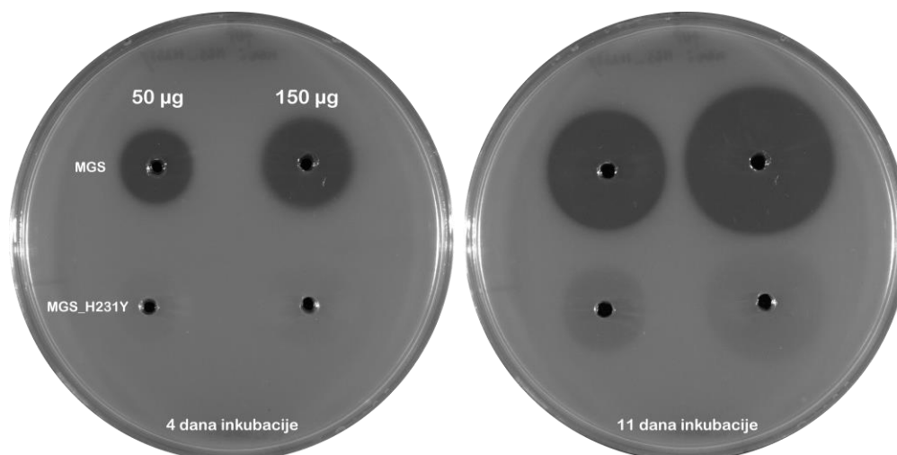
Slika 24. Test enzimske aktivnosti divljeg tipa MGS0156 i mutanta MGS0156_H231Y prema PLA u agaroznom gelu. U bunare su nanoseni enzimi u dvije količine, 50 i 150 µg: u gornjem redu MGS0156 i donjem redu MGS0156_H231Y. Ploča je inkubirana na 30 °C i slikana nakon 4 dana (slika lijevo) i 11 dana (slika desno) inkubacije.
