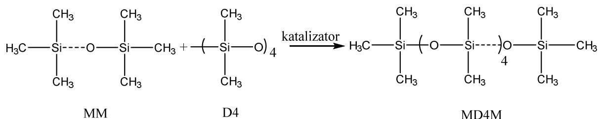
Shema 2. Dobivanje polidimetilsilosana reakcijom MM i ciklometikona D4 (ref. 4)
