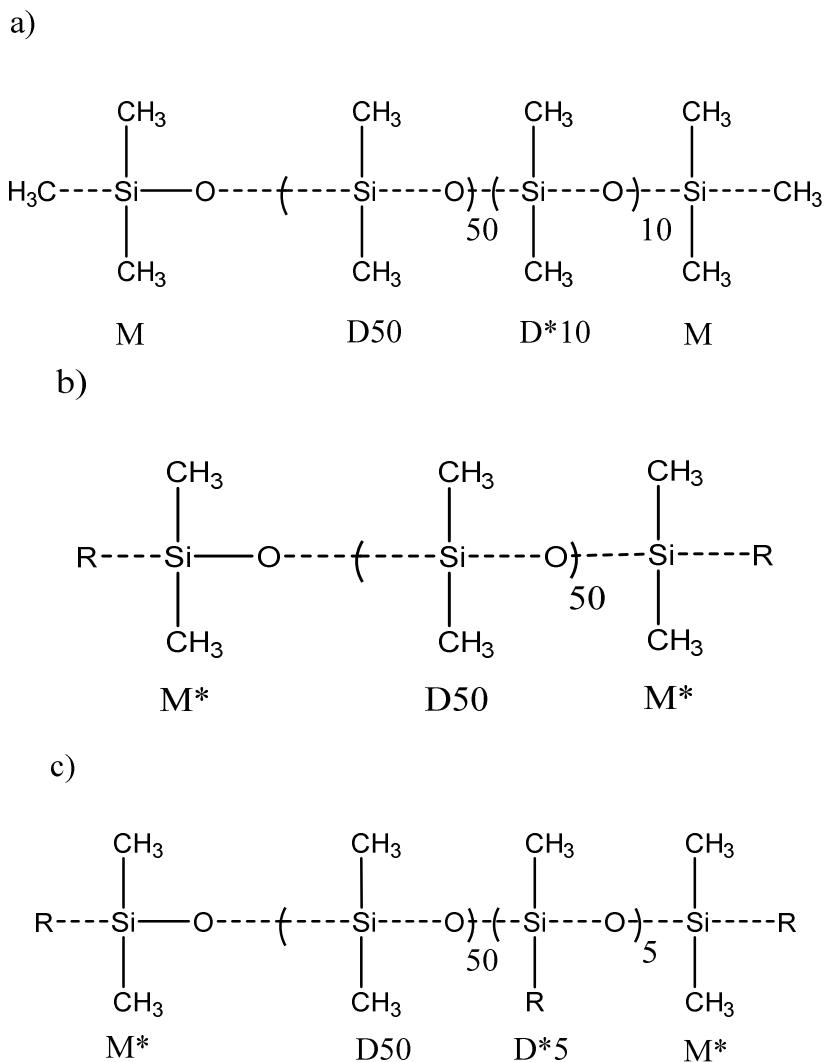
Slika 4. Strukture silikona: a) struktura češlja, b) multifunkcijska struktura, c) terminalna struktura<sup>4</sup>
