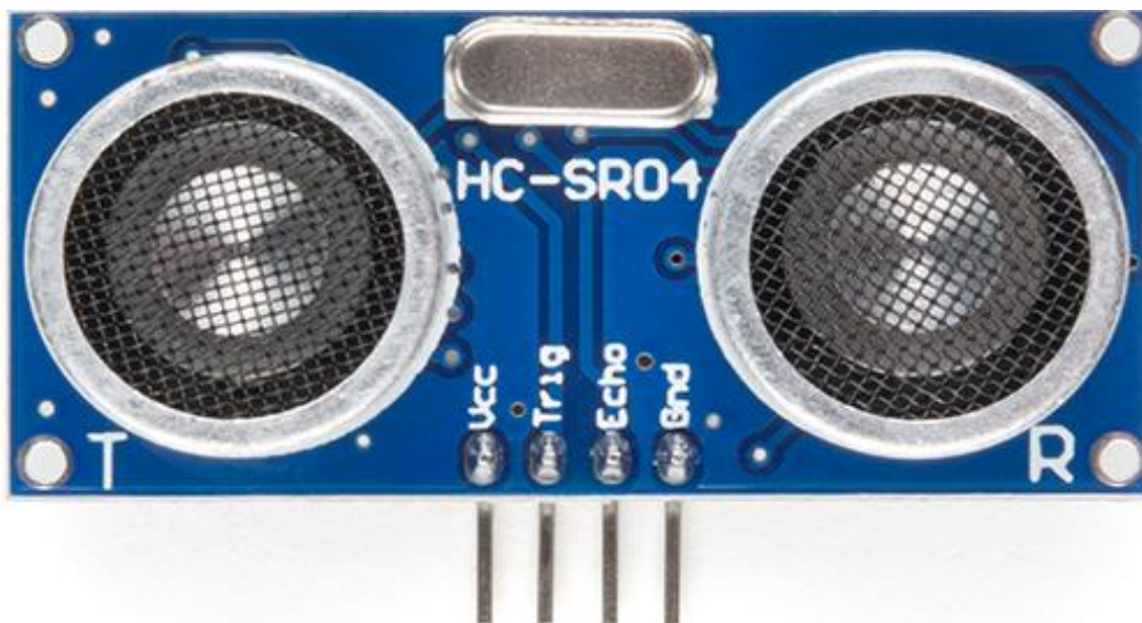
Slika 3 - HC-SR04 ultrazvučni senzor, slika preuzeta iz [5]
