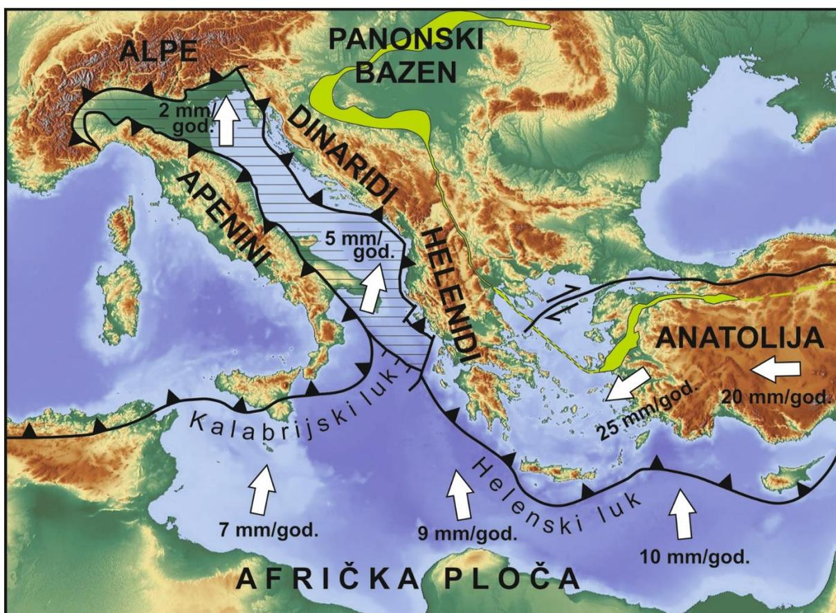
Slika 1.1. Geodinamska skica područja istočnog Sredozemlja i brzine konvergentnih kretanja Afričke, Anatolijske i Jadranske mikroplače prema Euroazijskoj ploči (Preuzeto iz [4]).
