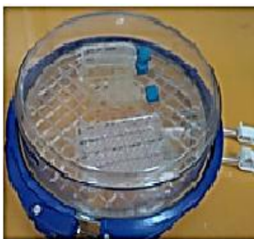
Slika 10. Posebno dizajnirana nepropusna modularna inkubacijska komora
